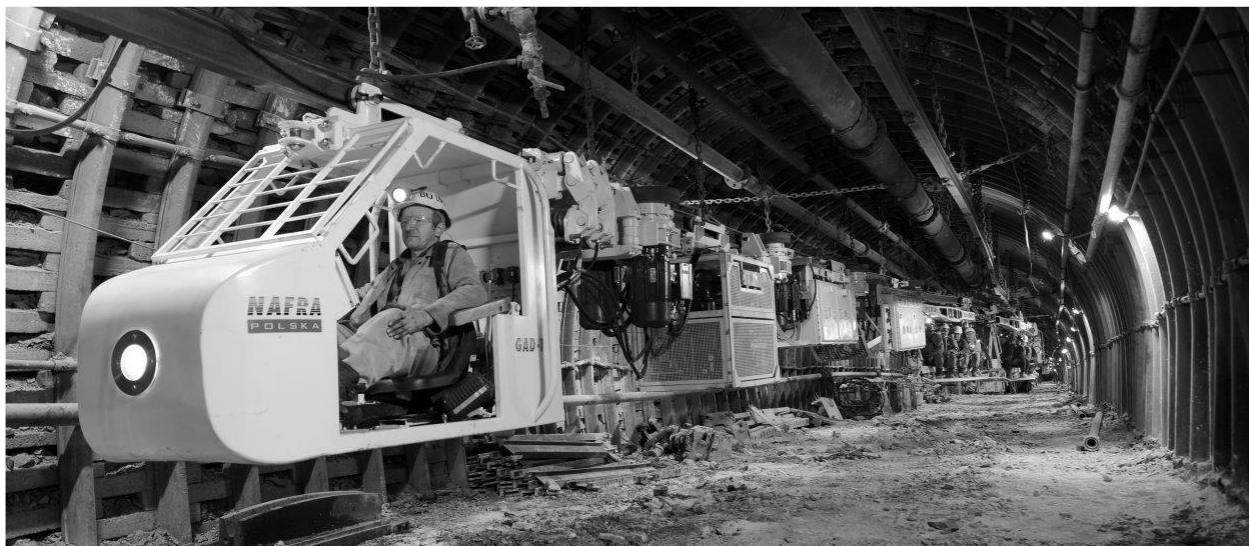
Rys. 1. Ciągnik GAD-1 pracujący w wyrobisku korytarzowym [8]
